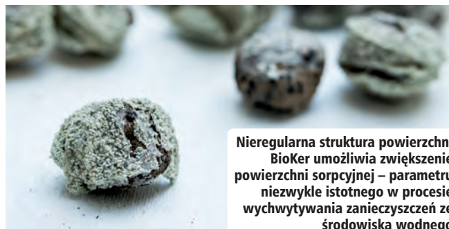
BioKer, lekkie kruszywo, może mieć różne postacie – w zależności od zastosowania
