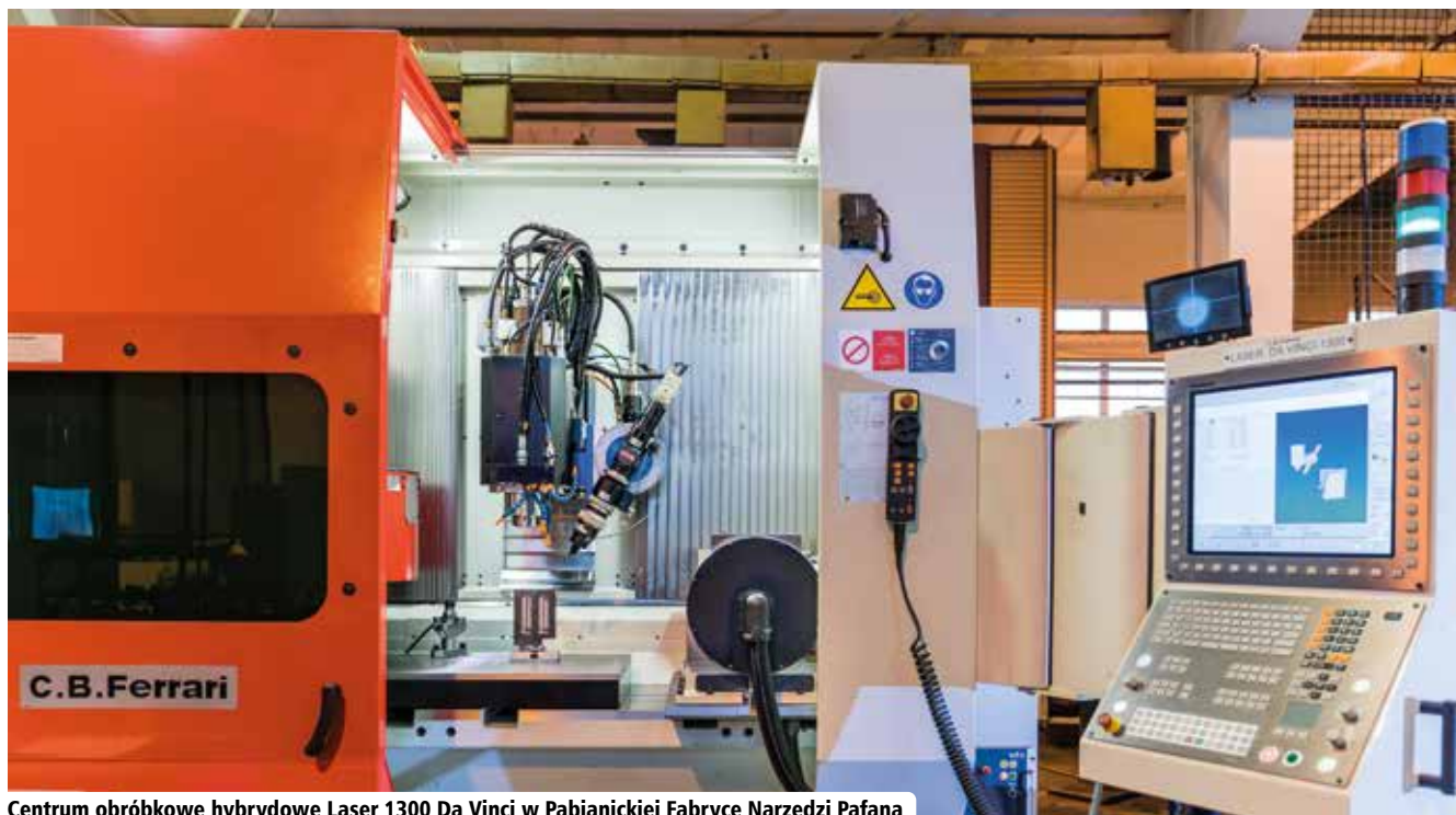
Centrum obróbkowe hybrydowe Laser 1300 Da Vinci w Pabianickiej Fabryce Narzędzi Pařana
