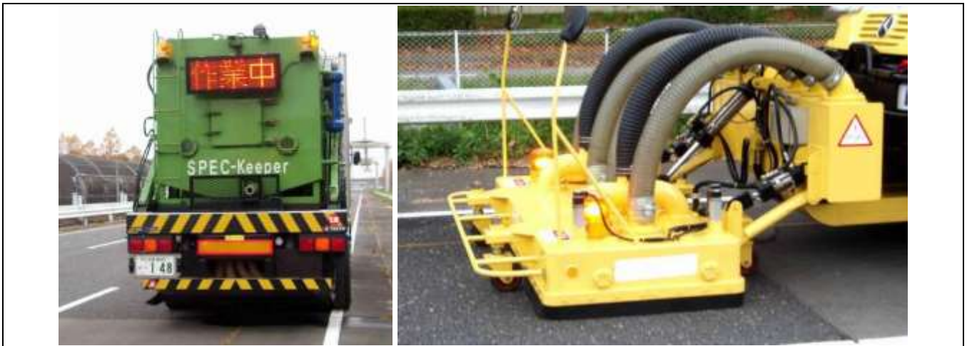
Rys. 65 Po lewej - samochód do czyszczenia cichych nawierzchni; po prawej - czyszczenie nawierzchni przy wykorzystaniu sprężonego powietrza (źródło: Noise reducing pavements in Japan - study tour report, Danish Road Institute, 2005, DRI-DWW noise abatement program )
