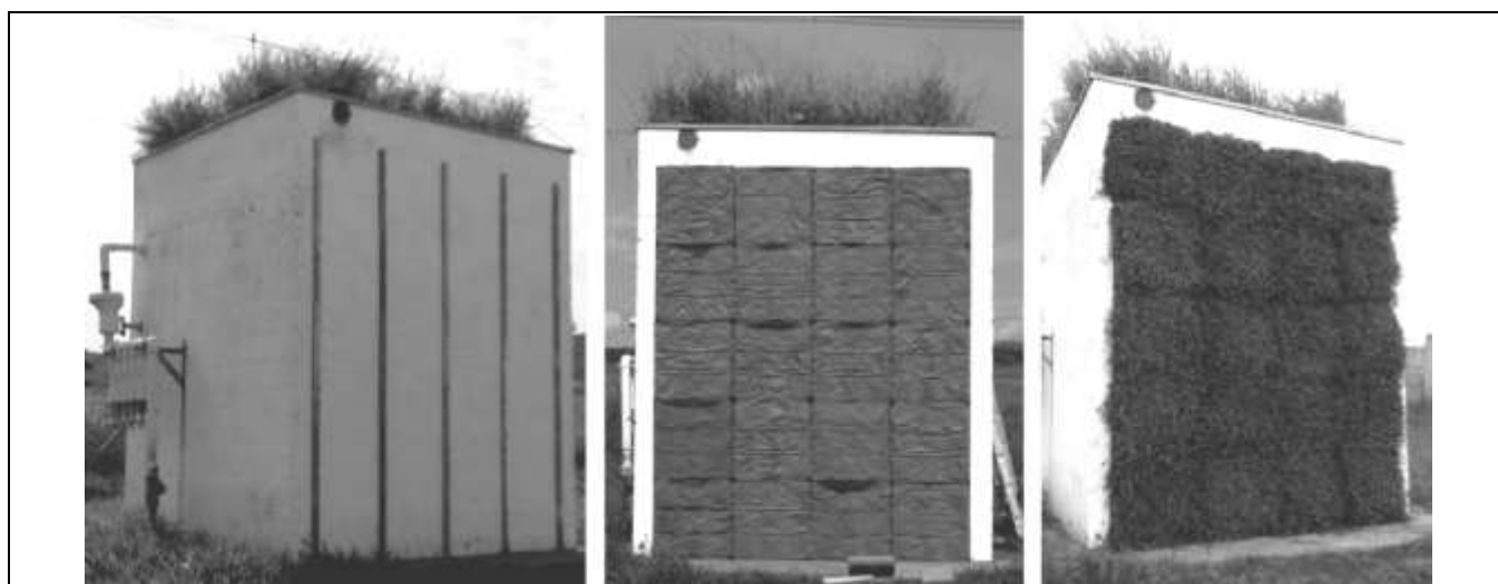
Rys. 49 Zielone ściany (green walls) o wysokim współczynniku pochłaniania jako rozwiązanie redukujące hałas w kanionach ulicznych; od lewej – Konfiguracja I – ściana z zamontowanymi słupami stalowymi, Konfiguracja II – ściana z 20 panelami ze sklejki na stalowych słupach + kieszenie z geowłókniny + podłoże; Konfiguracja III – jak w II + roślinność (źródło: jw.)
