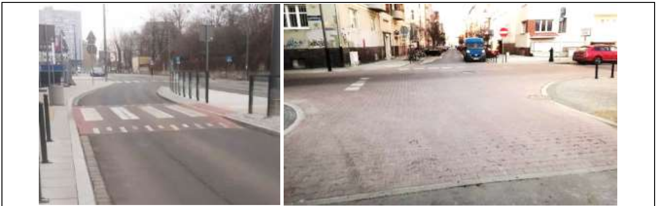
Rys. 22 Wyniesione przejście dla pieszych oraz wyniesione skrzyżowanie (materiały własne)
