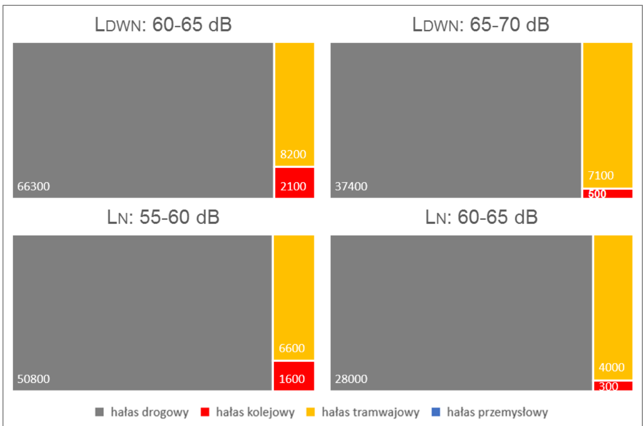
Rys. 9 Liczba mieszkańców Łodzi eksponowanych na różnego rodzaju hałas w środowisku w przedziałach 60-65 i 65-70 dB dla wskaźnika L_{DWN} oraz 55-60 i 60-65 dB dla wskaźnika L_N
